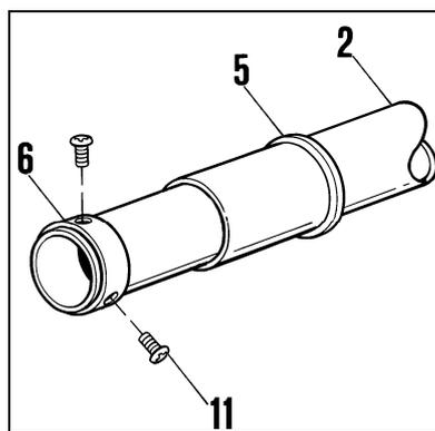
3. In corrispondenza dei 3 fori presenti nell'anello di spessoramento, forare con punta  $\varnothing 4\text{mm}$  l'asta (2);
