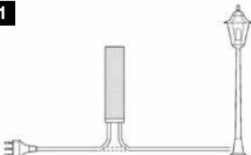
tionné directement dans le logement qui lui est destiné; pour éviter le risque d'infiltrations d'eau, il est conseillé de le positionner avec les câbles vers le bas.
